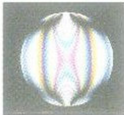
Figura 2.14. Ilustração de isoclínicas em um disco submetido a compressão diametral. (As isoclínicas são as franjas negras; as bandas coloridas são as franjas isocromáticas (ver sessão 2.4.2))
